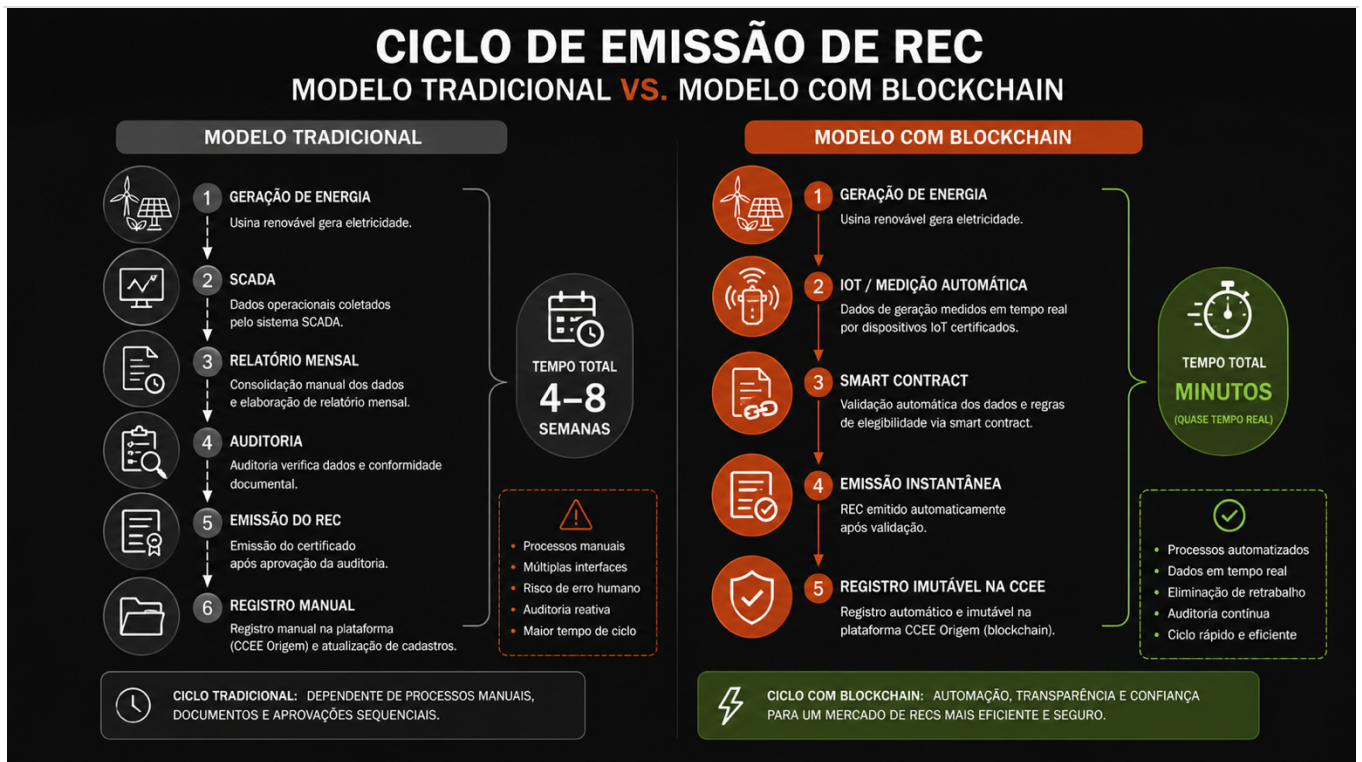
Figura 5. Ciclo de emissão de certificados REC: processo tradicional versus arquitetura baseada em blockchain.
